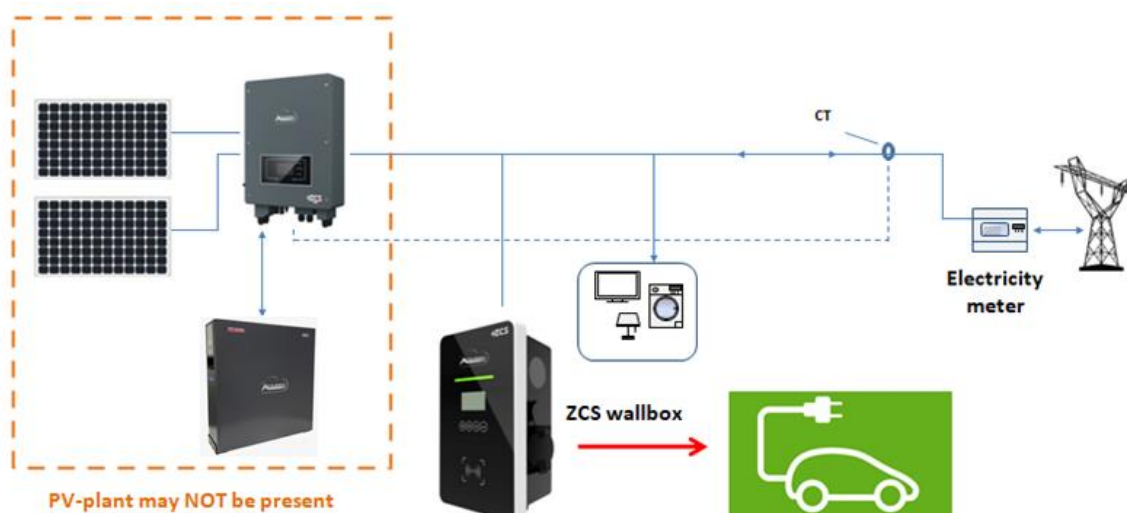
Figure 3 – Exemple d'une station de recharge connectée au PV (facultatif) et au réseau
